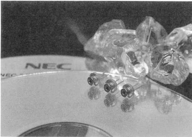
写真1-6 赤色の光線を出す半導体レーザー （日本電気㈱提供）
